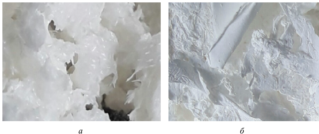
Рис. 50. Цифровые фотографии морфологической структуры сополиариленфталидов с p : q = 4 : 1 (а) и 1 : 15 (б), высаженных в метаноле из 5%-ного раствора в хлороформе
