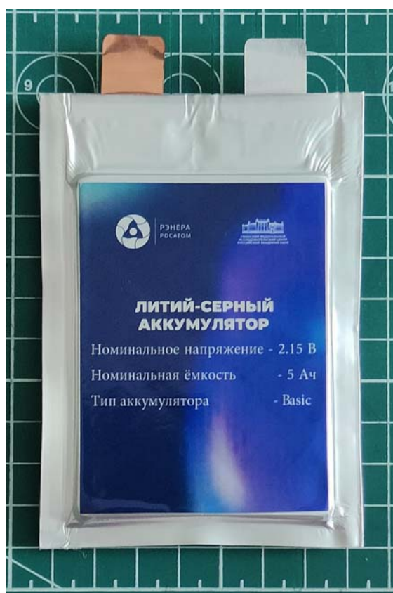
Рис. 48. Фото прототипа литий-серного аккумулятора в корпусе из металл-полимерного ламината
