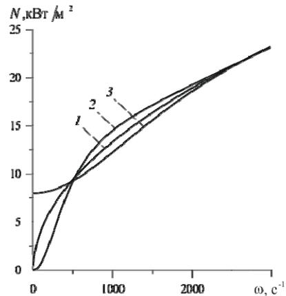
Рис. 1. Зависимости мощности акустического поля от круговой частоты в случае, когда пористая среда является высокопроницаемой ( $m = 0.2$ ,  $k = 10^{-12}$  м<sup>2</sup>)
