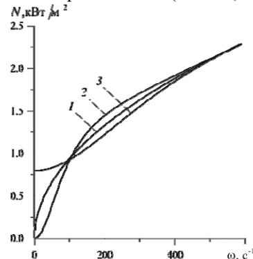
Рис. 2. Зависимость мощности акустического поля от круговой частоты в случае, когда пористая среда является низкопроницаемой ( $m = 0.1$ ,  $k = 10^{-13}$  м<sup>2</sup>). Линия 1 соответствует полубесконечной пористой среде ( $l = \infty$ ); 2 – пористая среда при  $x = l$  граничит с непроницаемой средой; 3 – пористая среда граничит с высокопроницаемой средой
