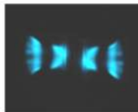
Рис. 3. Фотография СХЛ при многокластерном сонолизе насыщенного аргоном раствора 10^{-4} моль·л -1 люминола и 10^{-3} моль·л -1 NaOH в ДМСО. Экспозиция – 60 с, частота УЗ – 86.3 кГц
