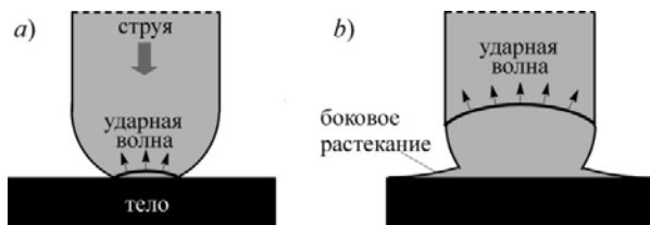
Рис. 1. Схема удара струи по телу. Черным обозначена область тела, серым – область жидкости. Кривые обозначают фронт ударной волны в два последовательных момента времени: а – радиус фронта равен радиусу области контакта, б – ударная волна распространяется по свободной поверхности струи, струя растекается по поверхности тела
