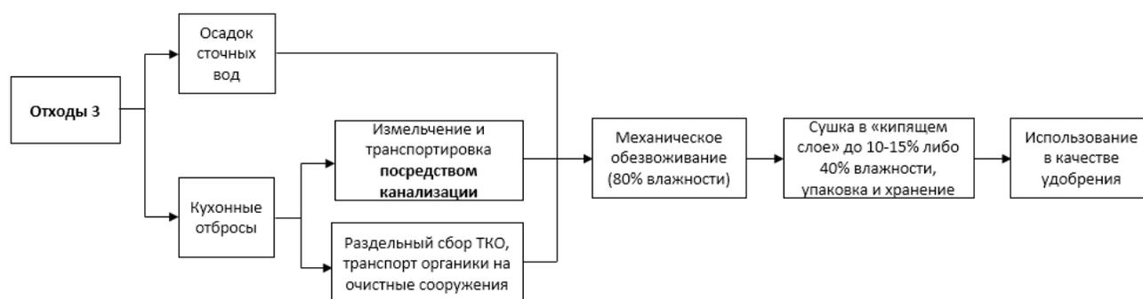
Рис. 5. Идеальная схема переработки «отходов 3»
