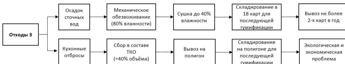
Рис. 2. Схема обращения с ОСВ и кухонными отбросами в г. Уфа
