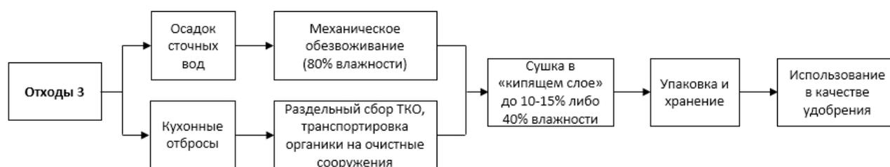
Рис. 4. Схема переработки «отходов 3» с запуском нового оборудования
