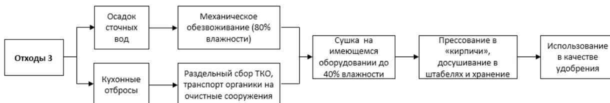
Рис. 3. Схема переработки «отходов 3» с сушкой на имеющемся оборудовании
